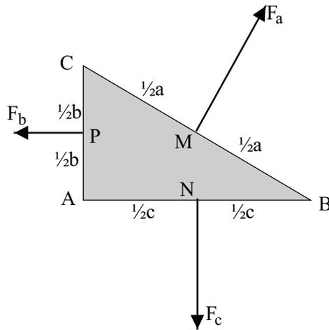
A condição de equilíbrio de rotação é válida para qualquer ponto escolhido no plano da placa. Deste universo de pontos, os pontos A, B e C, são fortes candidatos a serem escolhidos como ponto de rotação para a aplicação dos momentos.
