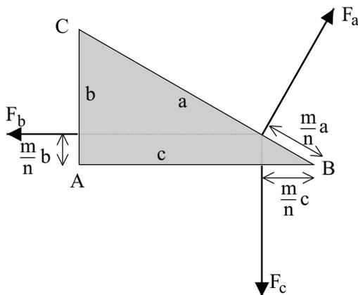
Utilizando os pontos A, B e C como centros de rotação, o leitor fica desafiado a obter a expressão do teorema de Pitágoras usando as condições dadas na figura anterior.
