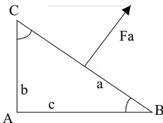
A força  $F_c$  deve ser perpendicular ao lado AB e, para obedecer à quarta condição, deve fechar o polígono (triângulo), isto é, sua extremidade deve ser coincidente com a origem da primeira força ( $F_a$ ) e sua origem deve ser a extremidade de  $F_b$ . Portanto, a extremidade de  $F_b$  deve ser a interseção da reta perpendicular a AB com a reta que contém a direção pontilhada indicada na figura.
